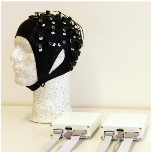
Figure 2.2: NIRSport : Prototype portable de la compagnie NIRx ©
