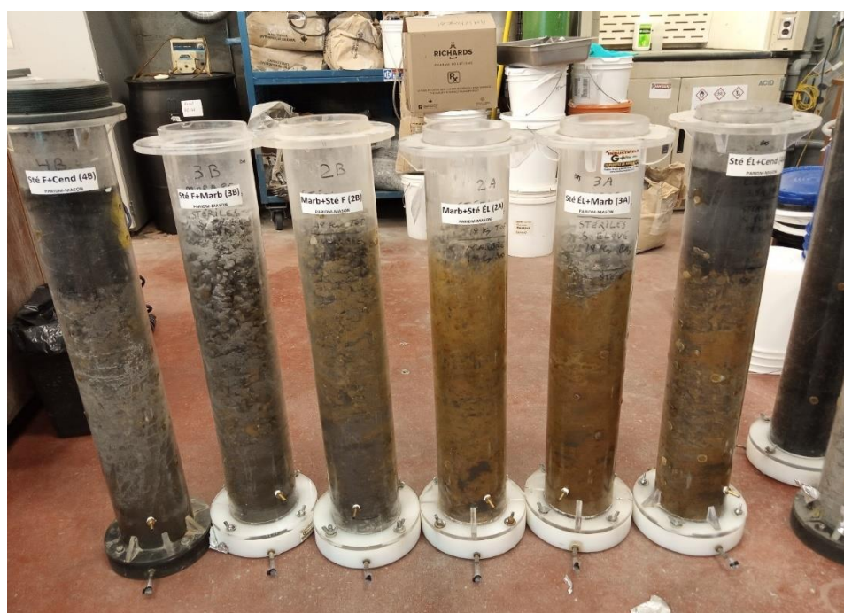
Figure 3.17 Photographie des différentes colonnes de stérile avec amendement (fin des essais)
