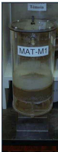
Figure 2.7 Photographie d'un essai en cellule humide (Villeneuve, 2004)
