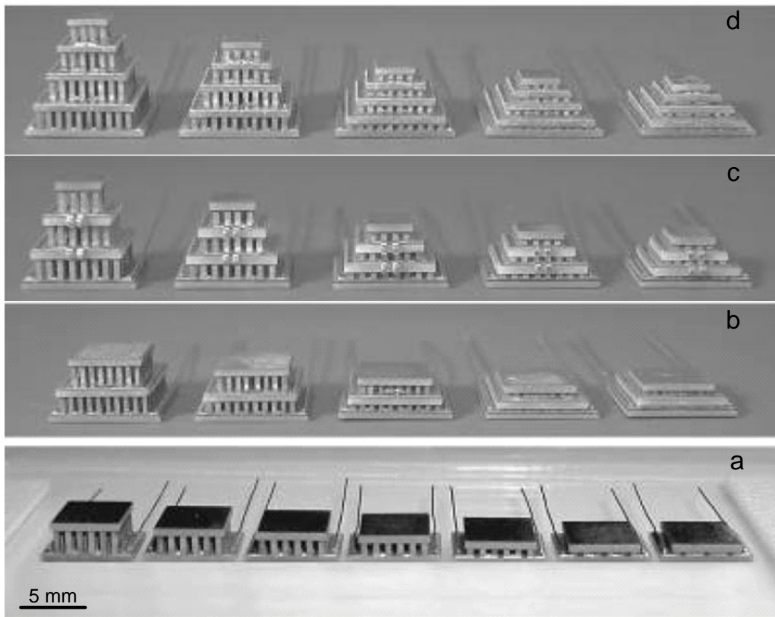
Figure 1.7 : Exemples de MTE de différentes hauteurs de patte TE (de 1,5 à 0,2 mm de gauche à droite) et à simple (a) ou multi-étages (b, c et d) [SEM 2006].
