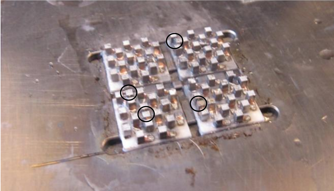
Figure 2.19 : Plaques céramiques avec pattes TE libérées juste après la découpe. La plaque en haut à gauche reprend de manière identique le motif du masque, les 17 pattes TE qui devaient être soudées l'on été sans qu'une patte ne se dessoude ou qu'un résidu reste. C'est par exemple le cas dans les autres plaques céramiques ou on retrouve un ou deux résidus indésirables par plaque (montrés par des cercles).
