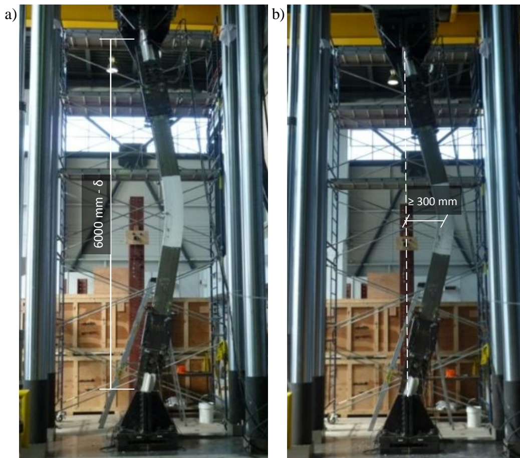
Figure 5-8: Aspect visuel du spécimen #1 en cours de test a) Premier flambement (cycle #8) b) Rotule plastique (cycle #14)
