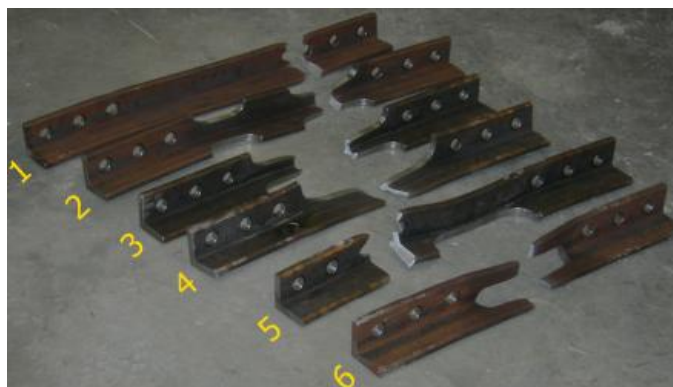
Figure 2-6: Mode de rupture des cornières pour différentes réductions de section (Desjardins et Légeron, 2010)
