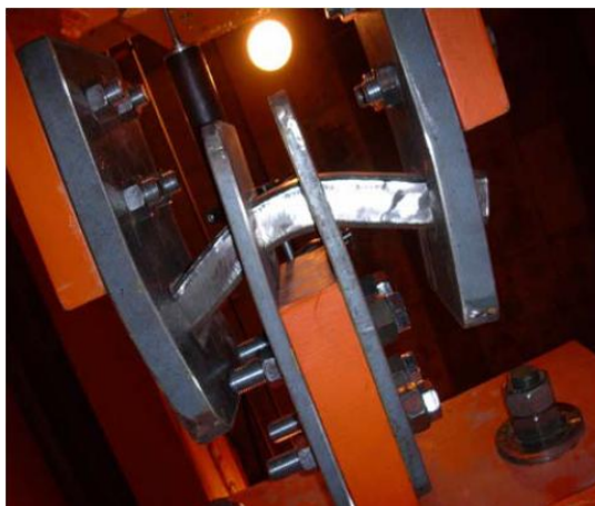
Figure 2-14: Déformations de la goupille et des plaques, effets d'encastrement (Vayas et al. 2005)
