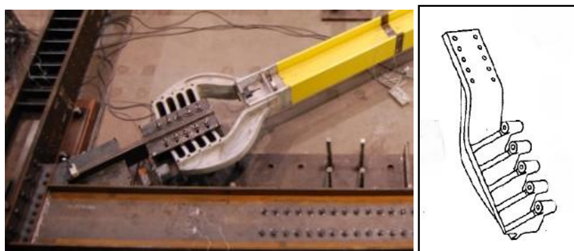
Figure 2-15: Connexion YBS et détail du bras (Gray et al. 2012)
