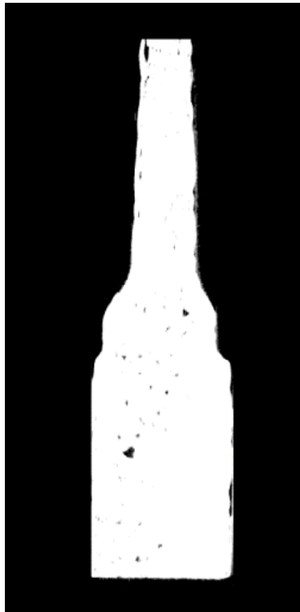
Figure 8-14 Coupe tomographique surexposée d'un pied d'aube où l'infiltration a été réalisée selon la première stratégie d'injection où les surfaces d'injection sont positionnées sur la face fine et la face épaisse
