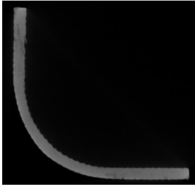
Figure 8-20 Coupe tomographique de la zone de jonction de la cornière où l'infiltration a été réalisée selon la première stratégie d'injection. Les surfaces d'injection et le filtre sont positionnés sur toute la surface de la pièce
