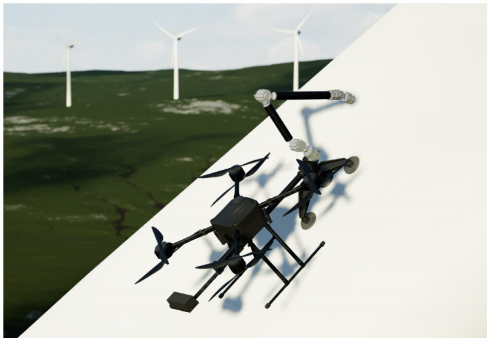
FIGURE 1.1 Rendu 3D du drone avec son bras robotique accosté sur une pale d'éolienne à l'aide du BAM
