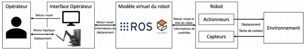
FIGURE 5.1 Chaîne de téléopération avec retour haptique et visuel
