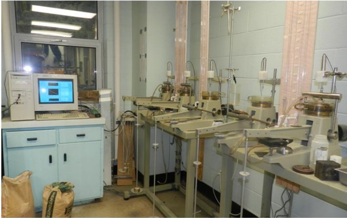
Figure 3-4 : Photographie des montages œdométriques et du système d'acquisition de données
