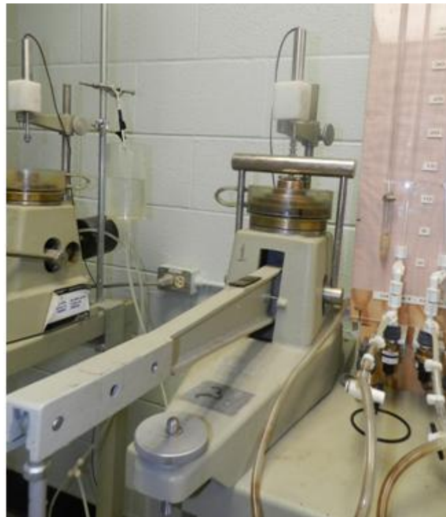
Figure 3-5 : Photographie d'un œdomètre lors d'un palier de compression
