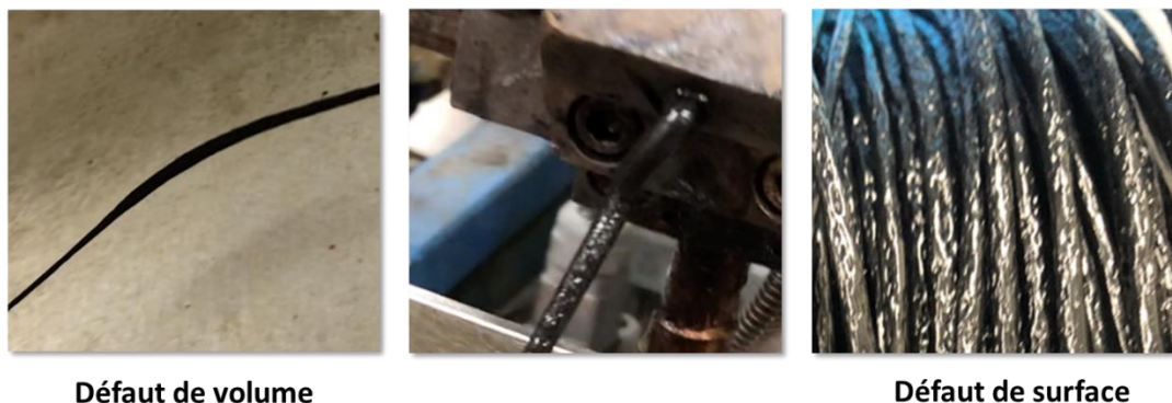
Figure 4.11 Défauts d'extrusion présents en sortie de filière.
