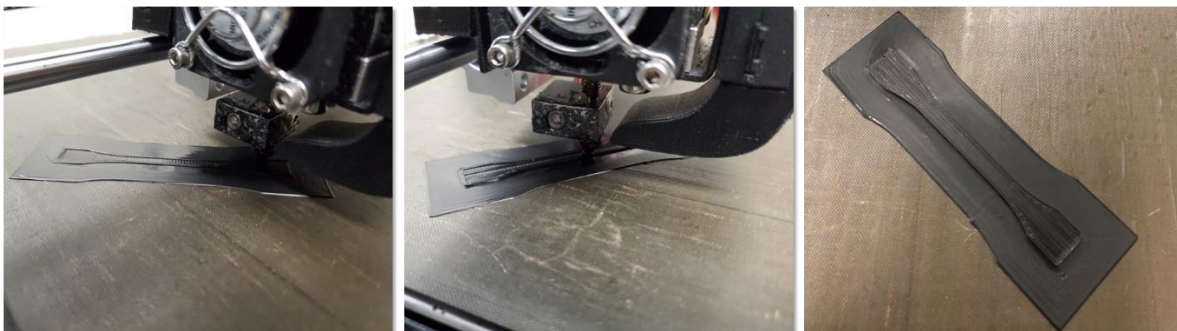
Figure 6.2 Impression d'une éprouvette ISO 527-2 1BA avec Brim sur les premières couches.
