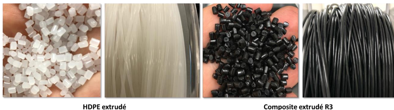
Figure 4.12 Granulés et filaments résultant de fabrication par extrusion : HDPE et R3
