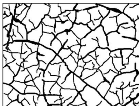
Figure 5.2 Évolution des craquelures lors du vieillissement de la face exposée (Fe) du HDPE.
