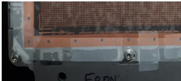
Figure 6.14 Repérage de couches de PCBs fabriquées pour le RTH 53x53 CUBs
