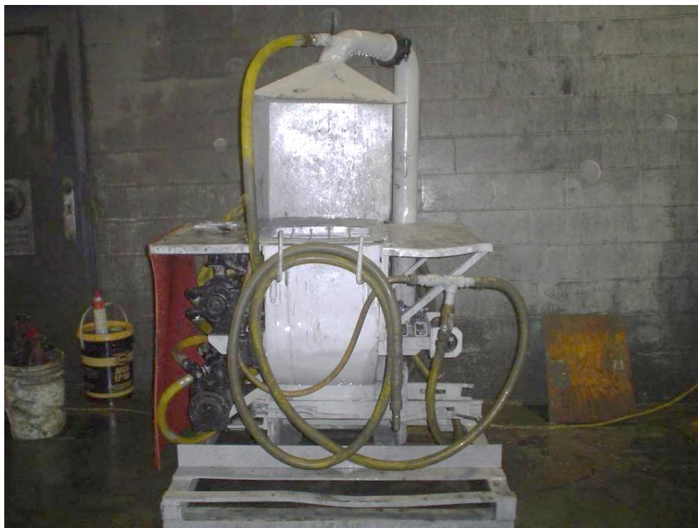
Figure 5.2 : Photo du malaxeur-pompe utilisé pour les mélanges des remblais consolidés en colonne à l'usine de remblai LRD
