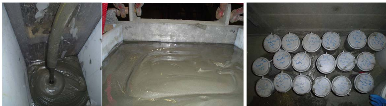
Figure 5.3 : Photos montrant le remplissage d'une colonne à l'aide du malaxeur-pompe utilisé ainsi que des moules de 3 po x 6 po de pour les mélanges de remblai LRD
