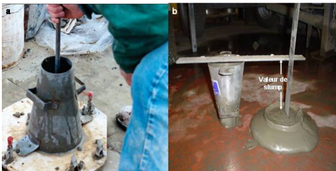
Figure 3.11 : Exemple de mesure de slump au cône d'Abrams de la pâte de remblai utilisée à la mine LVT
