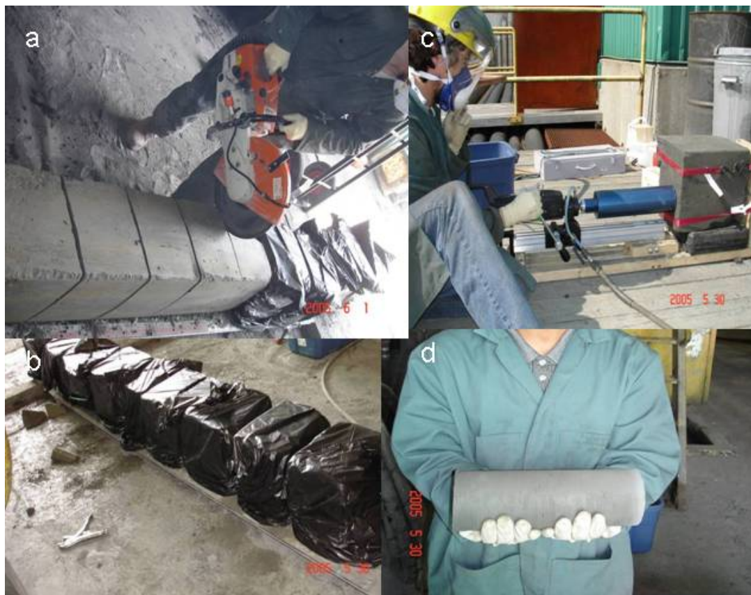
Figure 3.13 : Photos montrant les étapes post-démantèlement des colonnes de remblai en pâte à l'usine de remblai de la mine LVT: a) découpage de blocs avec une scie circulaire, b) recouvrement des blocs avec du plastique, c) carottage des éprouvettes d'essai, d) carotte d'éprouvette d'essai
