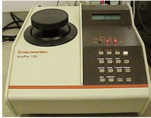
Figure 3.17 : Photo du pycnomètre à hélium Accupyc 1330 de Micromeritics utilisé au laboratoire pour déterminer la densité relative des échantillons des remblais en pâte
