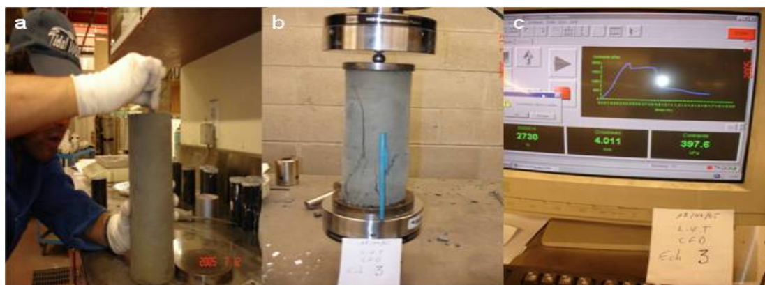
Figure 3.16 : Photos d'un essai de compression uniaxiale du remblai en pâte consolidé en colonne à l'usine de remblai de la mine LVT : a) rectification des surfaces de l'éprouvette d'essai, b) exemple de rupture d'une éprouvette, c) exemple de résultat visuel à l'écran.
