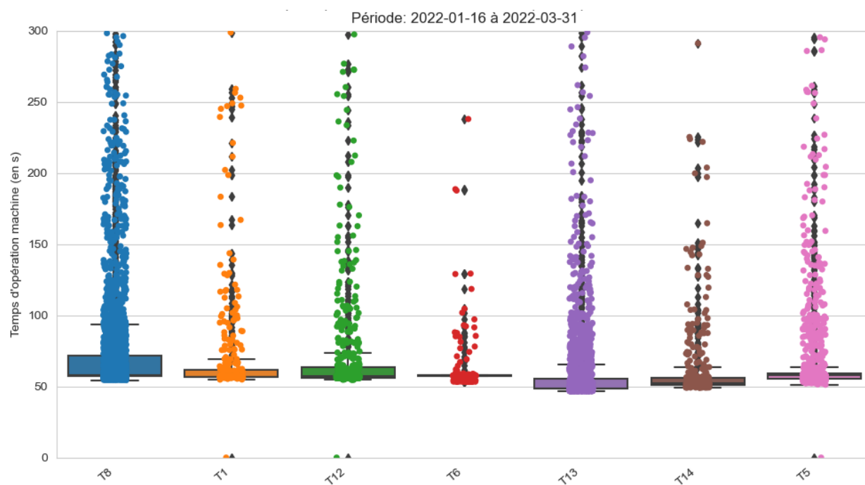
Figure 4.8 Distribution des temps d'opération par types de produits assemblés pour le profil 2
