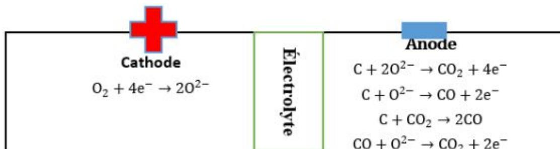
Figure 2.13 les différentes réactions se produisant aux interfaces électrodes (anode et cathode) et électrolyte d'une pile DCFC à oxyde solide
