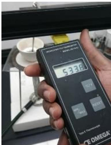
Figure 4.3 Test du thermocouple de type K utilisé pour mesurer la température pour le fonctionnement de la pile MC-LFC.
