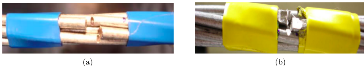
FIGURE 2.3 Exemples de défauts LF créés artificiellement dans un laboratoire. Adapté de [22]
