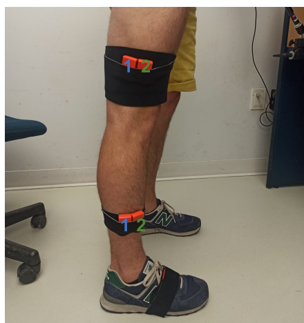
FIGURE 6.5 Emplacement des capteurs du jeu 1 et du jeu 2. Seuls les IMU de la cuisse et du tibia changent. Les IMU du sternum, du pelvis et du sternum sont identiques pour les deux jeux.
