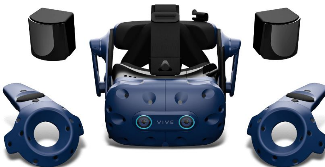
Figure 3.19 Le HTC Vive Pro Eye avec ses contrôleurs
