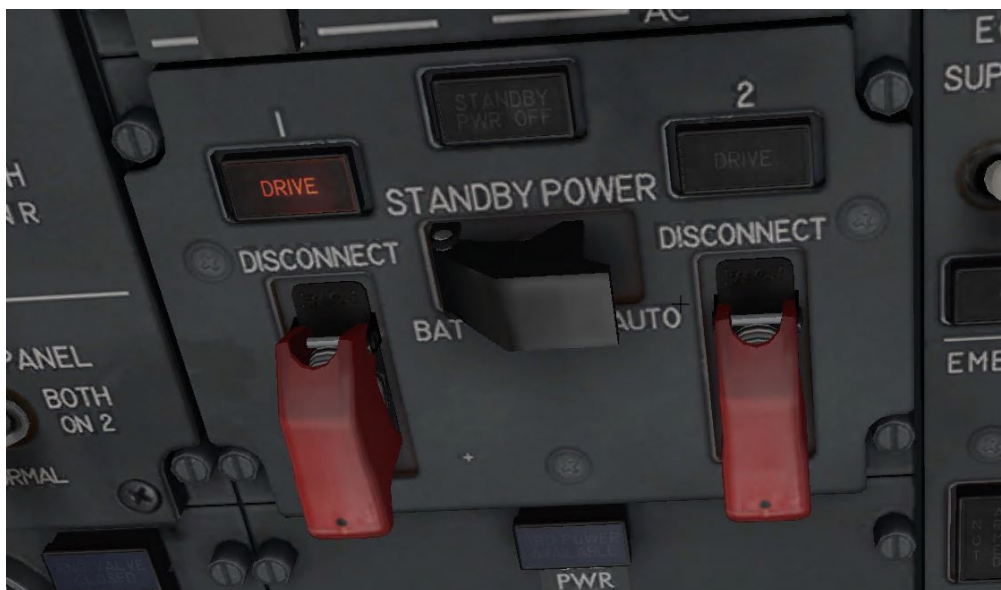
Figure 3.15 L'interrupteur à activer lors de la panne 'DRIVE'
