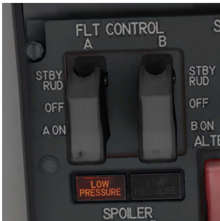
Figure 3.14 L'interrupteur à activer lors de la panne 'FLIGHT CONTROL LOW PRESSURE'
