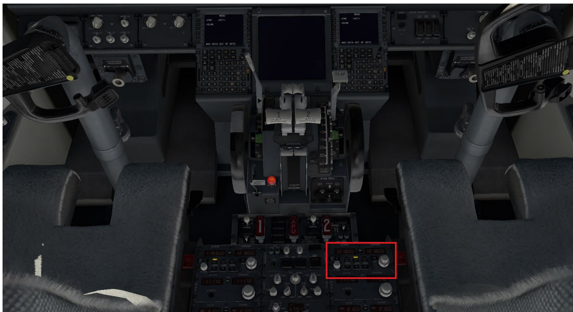
Figure 3.12 Le bas du cockpit, l'emplacement du manipulateur de fréquences radio du copilote est mis en évidence
