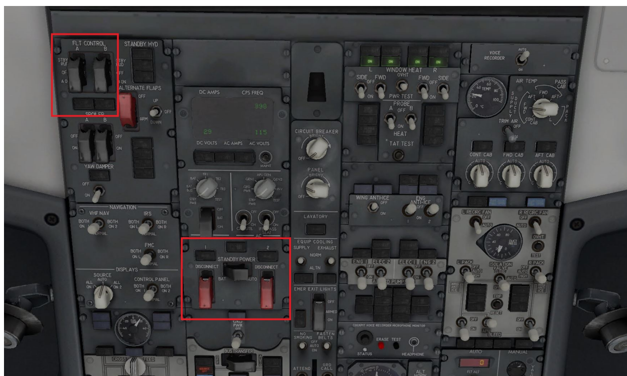
Figure 3.16 La partie haute du cockpit indiquant l'emplacement des interrupteurs utilisés pour les pannes 'FLIGHT CONTROL LOW PRESSURE' et 'DRIVE'
