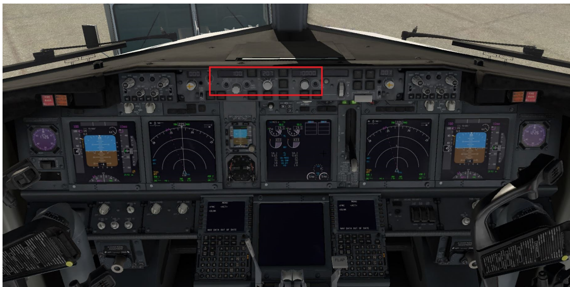
Figure 3.13 L'avant du cockpit, l'emplacement des manipulateurs de vitesse, cap et altitude (de gauche à droite) est mis en évidence.
