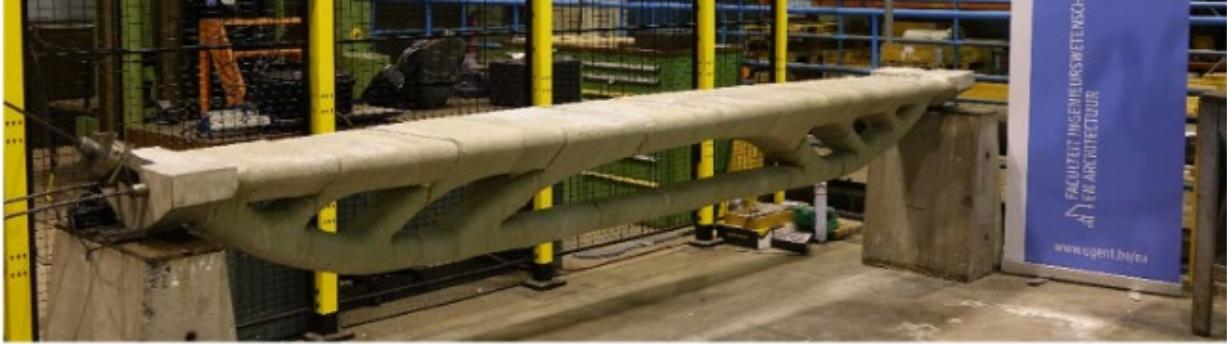
**Figure 3-14 : Poutre dimensionnée selon les résultats de l'optimisation topologique et construite par impression 3D (tirée de : (Vantyghem et al., 2020))**
