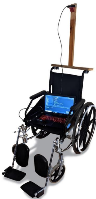
Figure 3.17 Installation utilisée pour détecter et classer les poignées de porte
