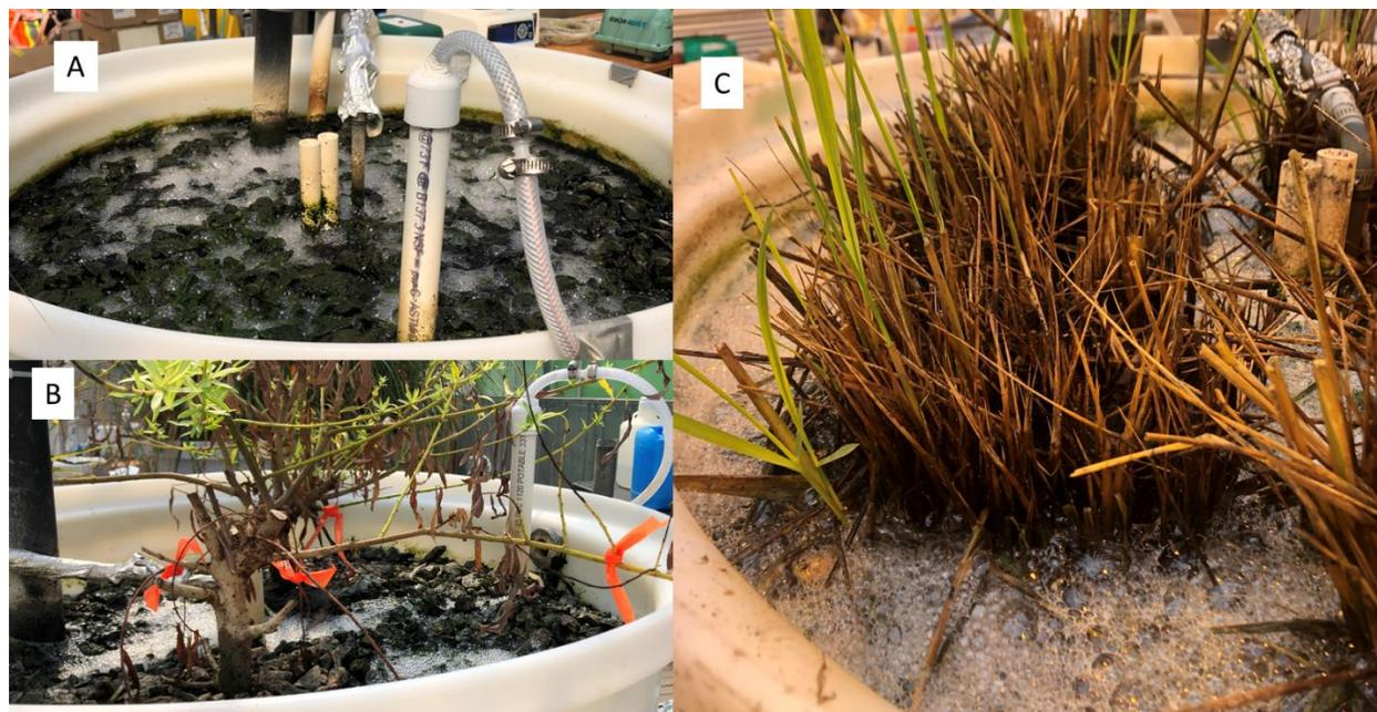
Figure E7 Photo du développement des algues et de la présence de la mousse à la surface de A) FPT, B) FPW\_AX, C) FPS\_AX
