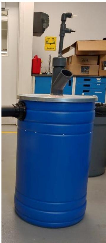
Figure C2 Photo du réacteur UASB à la suite de sa construction (Boutin, 2020)
