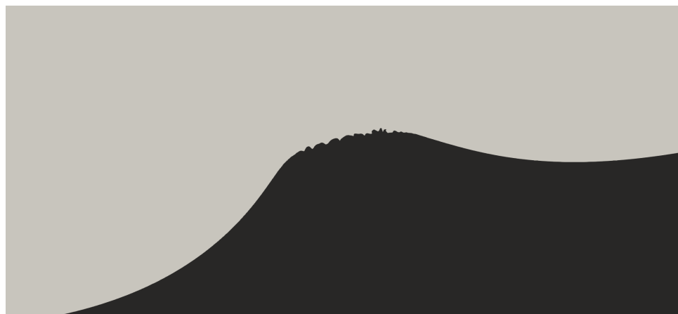
FIGURE 4.21 Déferlement anticipé dû aux instabilités accrues ( t = 0.17s )
