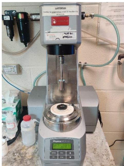
Figure 4-2 Anton Paar MCR 501 avec géométrie Couette montée
