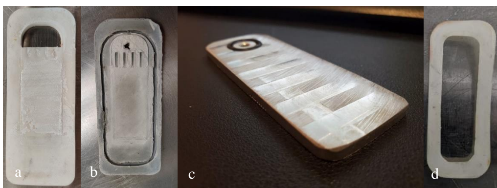
Figure 5-9 Photographies des solutions successives testées pour résoudre le défaut de planéité du composite. (a) Joint TPE plus dur que le joint d'origine, (b) plaquette ABS avec joints toriques, (c) plaquette en aluminium avec joint torique et joint plat (d).
