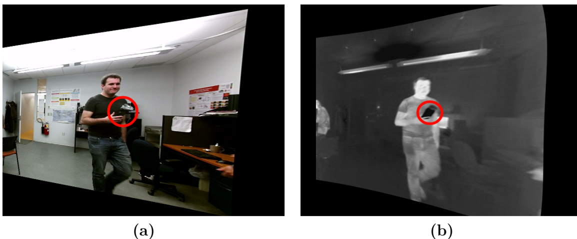
Figure 1.5 (a) Image RGB contenant un objet froid dans le jeu de donnée LITIV 2018 [1]. (b) Image LWIR contenant un objet froid dans le jeu de donnée LITIV 2018 [1].
