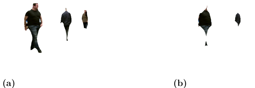
Figure 4.4 (a) Image RGB à 4 canaux avec érosion de 5 pixels (b) Image RGB à 4 canaux avec érosion de 15 pixels.
