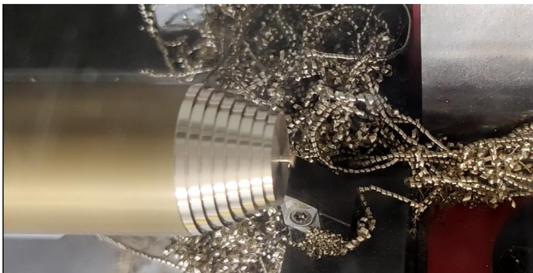
Figure 5.27 Contournage d'ébauche correspondant au Workingstep : Rough contouring
