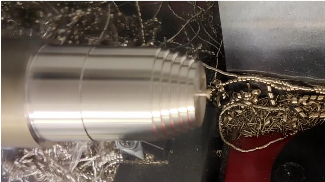
Figure 5.28 Contournage d'ébauche correspondant au Workingstep : Rough contouring
