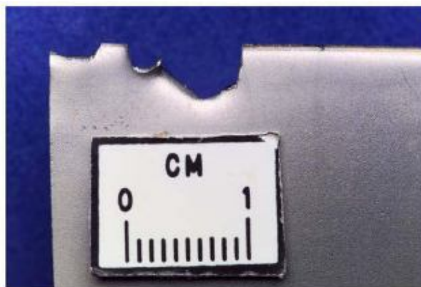
Figure I- 4 : Représentation d'un cycle de pompage (à gauche) et d'une aube endommagée par le pompage (à droite) [1], [2]
