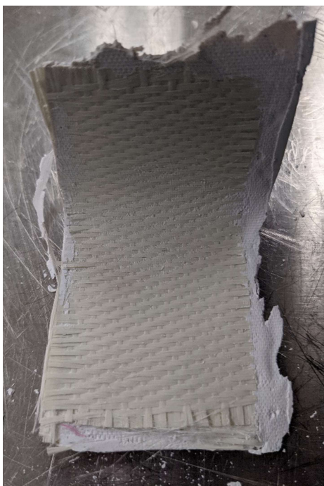
Figure 6.10 : Pièce résultant d'un essai préliminaire avec préforme 2D, démoulée. Les bavures sur le côté sont dues au fait que de grands espaces sont nécessaires sur le pourtour afin de compenser le glissement des plis lors du transfert après déliantage.
