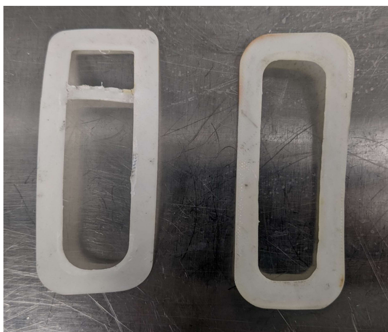
Figure 5.19 : Joints imprimés en TPU pour le moule version XX (gauche) et XY (droite). La version XX diffère de la version XY principalement avec la présence du repli.
