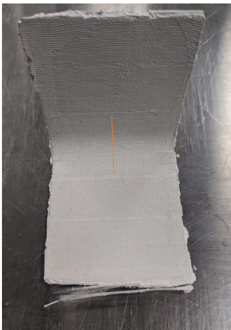
Figure 6.15 : pièce 123 123-2 après démoulage. Le trait orange représente la section examinée sur la Figure 6.16.
