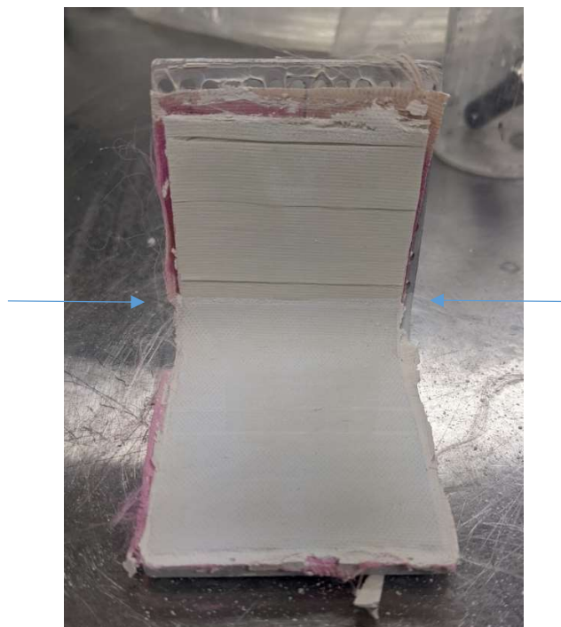
Figure 6.19 : Vue du côté intérieur de la pièce tirée de l'essai 123 023-1. On distingue bien le front de construction entre le bas bien construit et le haut non construit. Les flèches bleues marquent le niveau du front.
