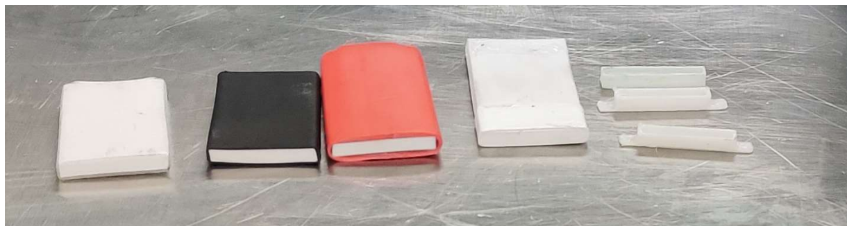
Figure 5.15 : Différentes solutions explorées pour résoudre les problèmes d'étanchéité. Les quatre blocs de membrane filtrante sont chacun entourés d'un polymère différent. De gauche à droite : Gaine transparente en plastique, gaine noire en caoutchouc, gaine rouge en caoutchouc avec enrobage interne, ruban de Téflon. Le caoutchouc sans enrobage (noir) a donné de meilleurs résultats lors de tests et a été retenu. Tout à droite : Joint individuel en TPU imprimé 3D.
