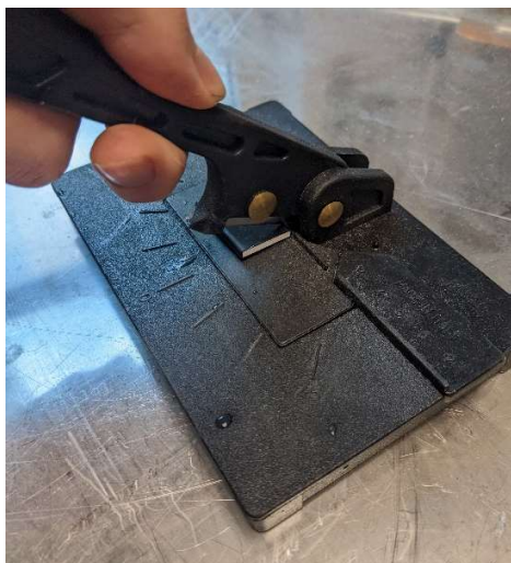
Figure 5.17 : Découpe d'une tranche de filtre avec un massicot pour la configuration XX.
