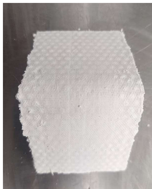
Figure 6.11 : Pièce résultant d'un essai de fabrication avec une préforme UD découpée dans une chute avec le même liant que les cornières.
