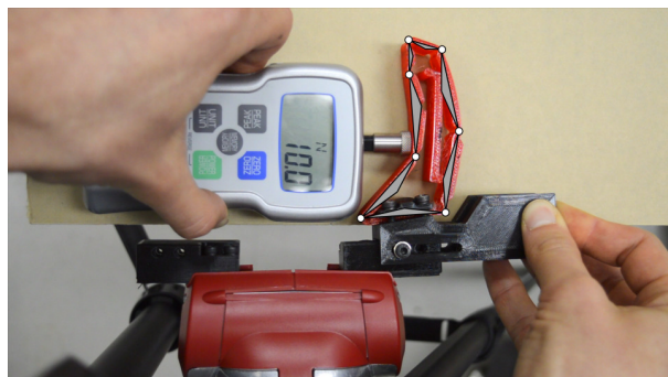
(a) Appui d'une force de 10N en mode faible-raideur (barre interne déclenchée)
