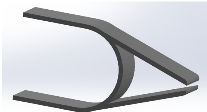
(b) Attache compliant représentée en position fermée (tiré de Wikimedia Commons, auteur : I.Elgamal sous licence CC BY-SA 4.0)
