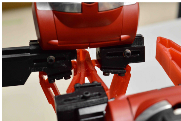
(a) Clips de la barre interne (Le bout du doigt est pincé par les doigts de l'autre bras)
