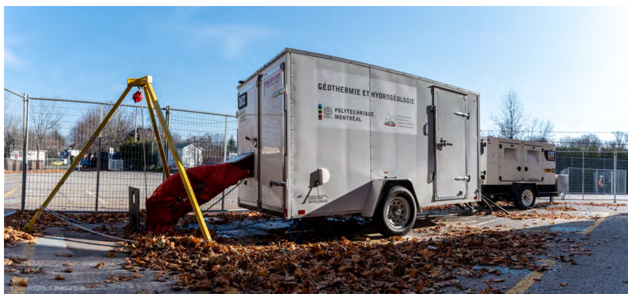
Figure 5.10 Unité de réponse thermique mobile dans la cour de l'École de la Clé-des-Champs.
