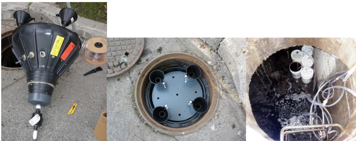
Figure 2.4 Dispositif multi-entonnoirs pour la collecte des eaux de ruissellement urbain dans une chambre d'aqueduc
