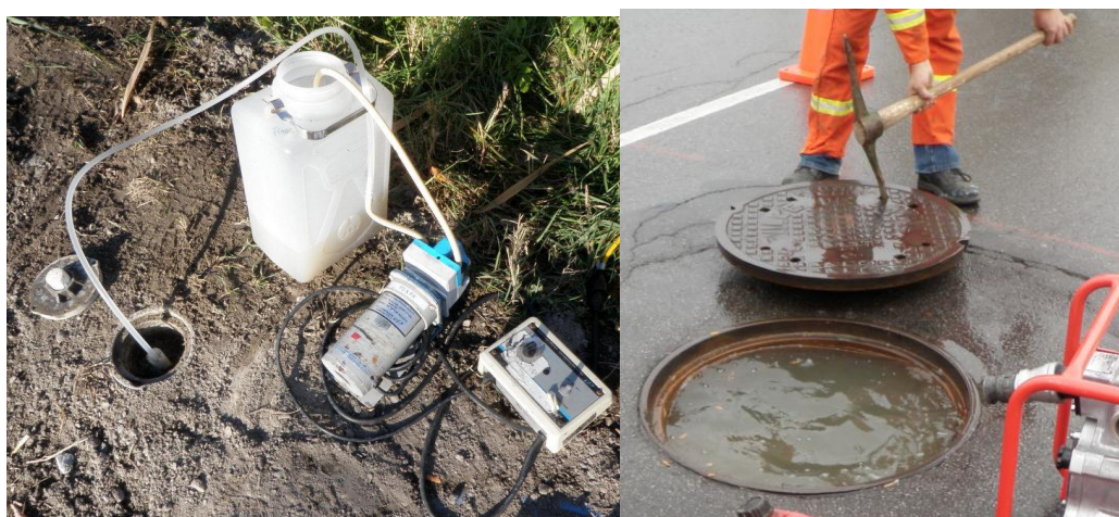
Figure 2.2 Échantillonnage de l'eau souterraine peu profonde (à gauche) et de l'eau d'une chambre d'aqueduc inondée (à droite) à l'aide d'une pompe péristaltique (photo de gauche)
