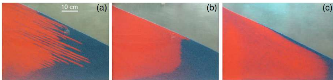
FIGURE 2.17 Photographies des trois configurations définies de schémas d'empilements obtenables après la réalisation d'un essai réel de déposition d'échantillons granulaires bidisperses : (a) état stratifié ; (b) état ségrégué ; (c) état mélangé. L'échantillon bidisperse déversé est composé de larges grains sphériques bleus et de fines particules sphériques rouges (Tiré de Fan et al., 2012).
