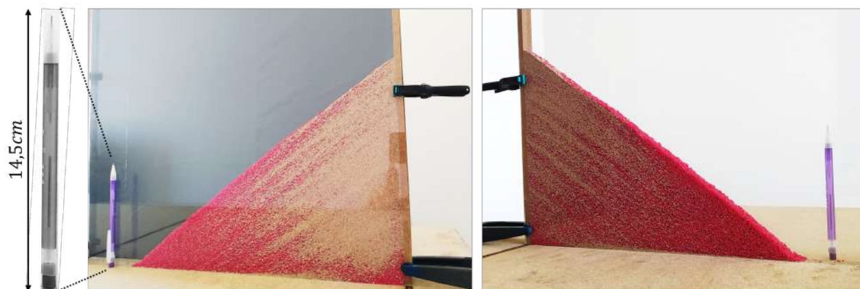
FIGURE 3.5 Schémas d’empilements comme résultats obtenus au terme des dépositions du premier mélange granulaire dans une cellule d’essai quasi-2D.
