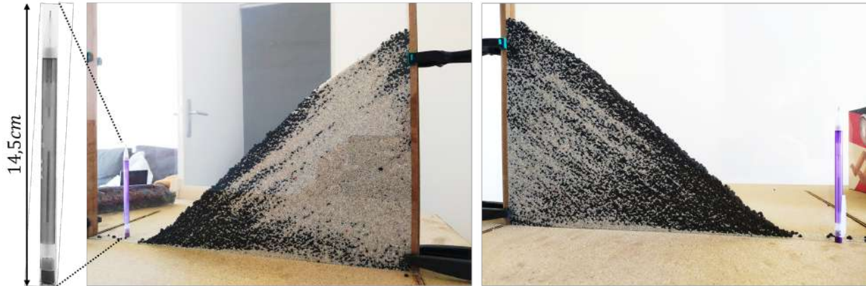
FIGURE 3.6 Schémas d'empilements comme résultats obtenus au terme des dépositions du second mélange granulaire dans une cellule d'essai quasi-2D.
