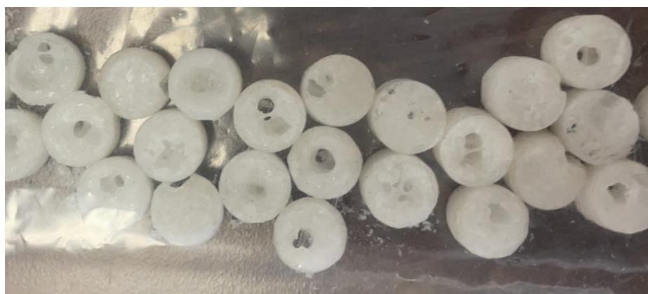
Figure 6.13: Défauts de fabrication des moules macroporeux ayant subis un recuit de 45 minutes
