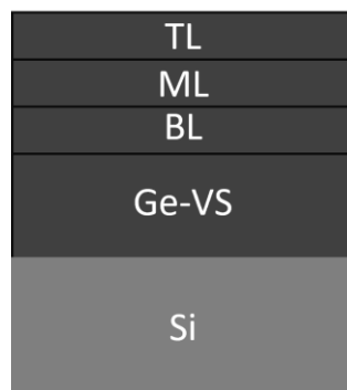
Figure 2.8 Empilement des différentes couches permettant de minimiser la contrainte.
