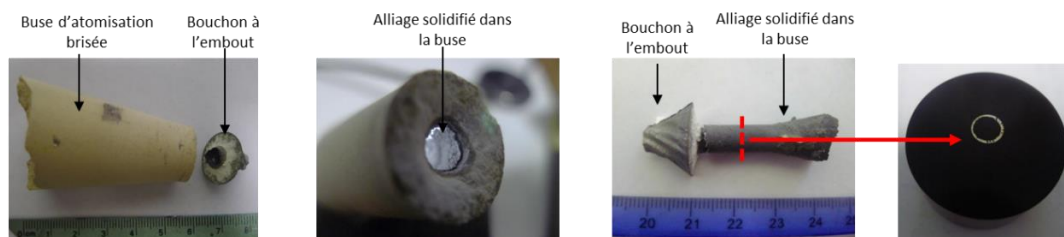
Figure 3.3 Photographie du bouchon formé à l'embout de la buse d'atomisation et préparation d'une coupe transversale de l'alliage solidifié dans la buse d'atomisation.
