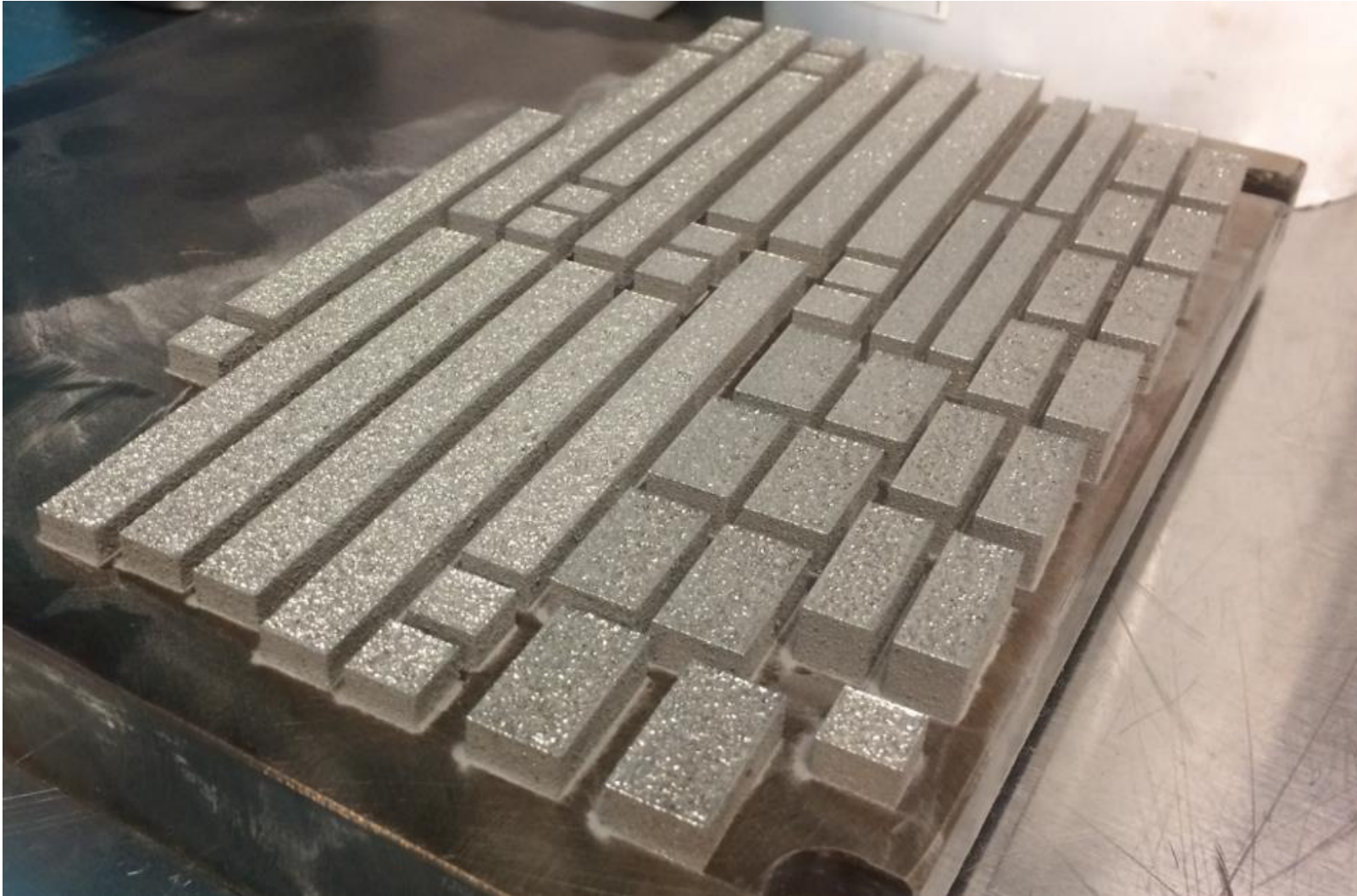
Figure 3.28 Plateforme d'impression présentant les échantillons utilisés pour l'évaluation des propriétés d'intérêt de l'acier AFA6.
