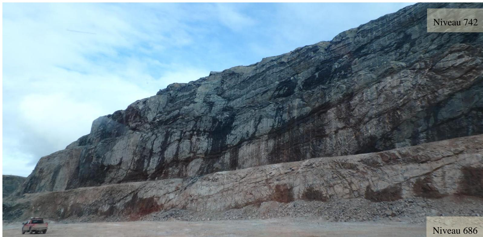
Figure 6.9 Implémentation du design entre les niveaux 742 et 686 (Secteur Central)
