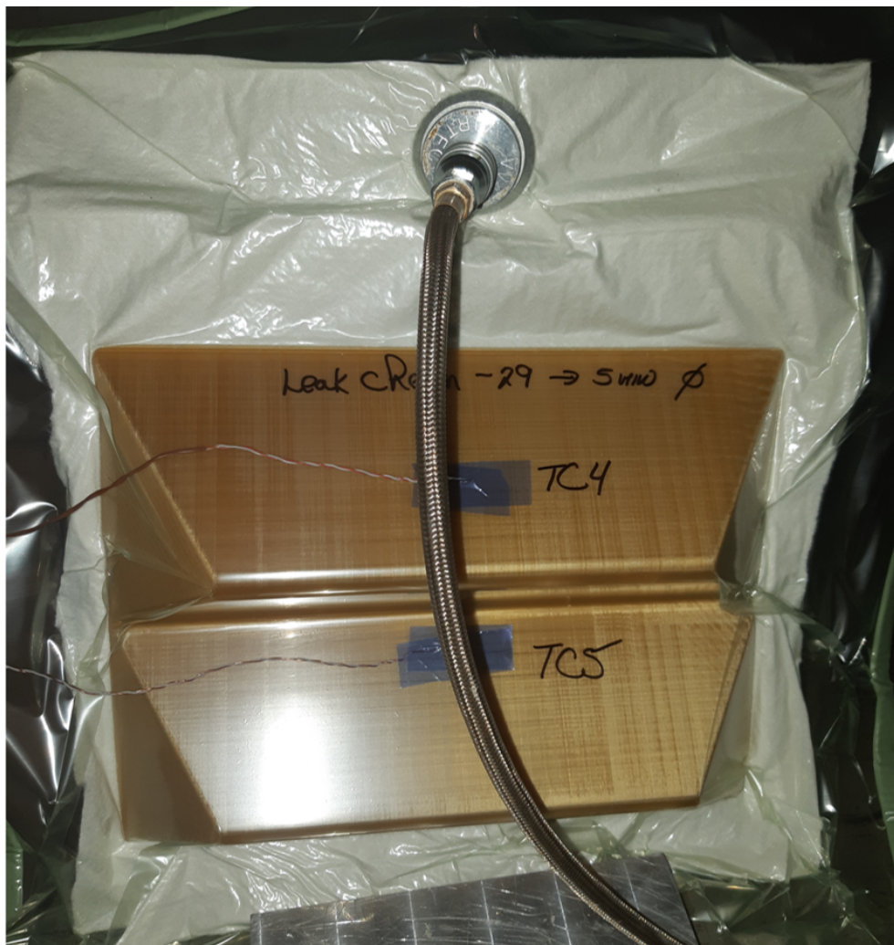
Figure G.5 Montage d'infusion sur l'outillage en PEI avec la position des thermocouples (TC)
