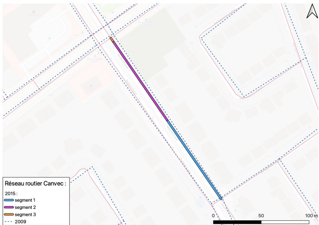
Figure 3.17 Découpage en tronçons de 100 m – réseau 2015
