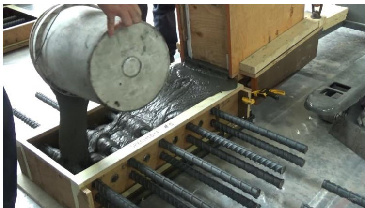
Figure 5.61 Fin du remplissage du coffrage du spécimen DNCO par passes à l'aide d'un seau
