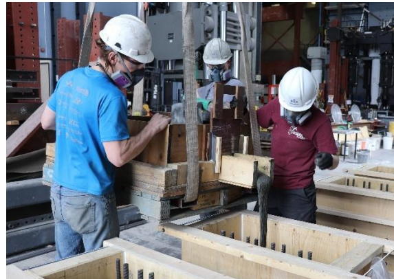
b) Coulée d'une semelle
