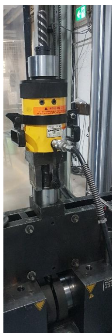
Figure 4.10 Montage d'engagement par pré-tension seulement
