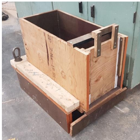
Figure 5.6 Réservoir utilisé pour la coulée des joints
