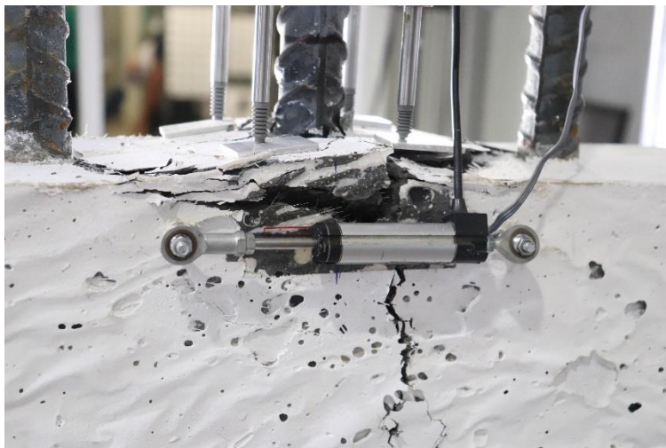
Figure 6.8 Soulèvement du béton avec l'arrachement de la barre
