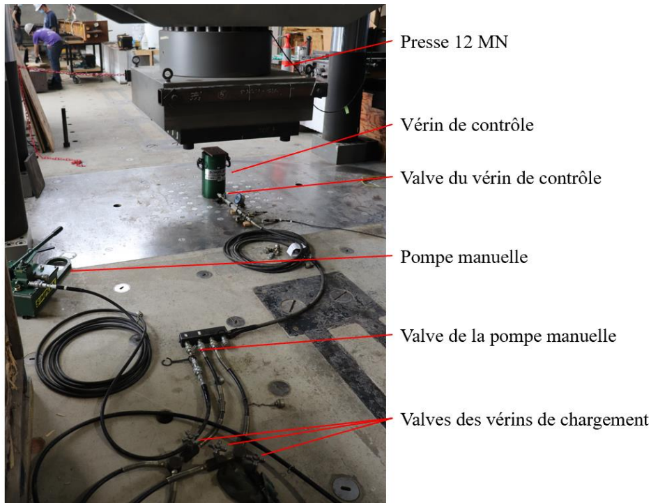
Figure 5.36 Système de vérins pour le chargement
