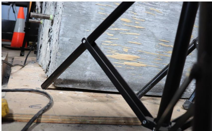
Figure D.5 Soulèvement de la semelle inférieure
