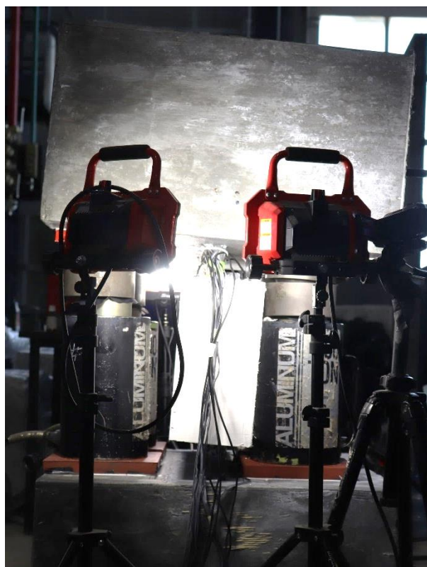
a) Inclinaison du spécimen entraînant la semelle
