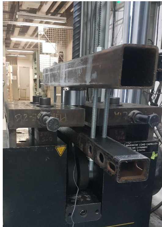
Figure 4.11 Montage d'engagement actif avec pré-tension
