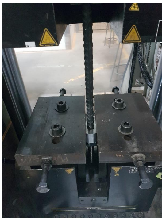
Figure 4.8 Montage d'engagement passif
