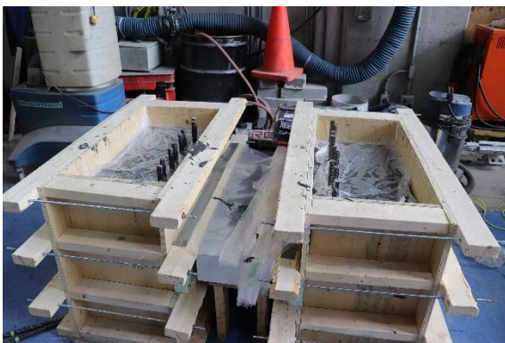
c) Pellicule plastique entre les gâchées
