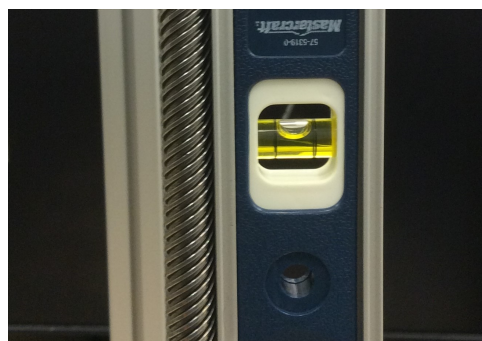
Figure 3.4 La verticalité de la vis sans fin est mesurée et vérifiée (ceci se fait plusieurs fois).
