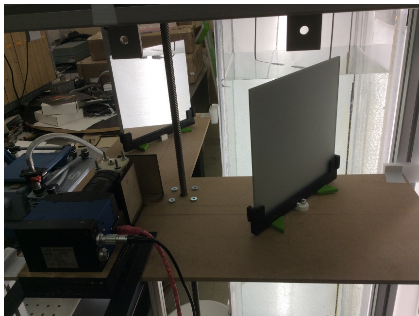
Figure 3.7 Plateforme mobile avec tous les objets (une caméra et trois miroirs) mis au-dessus.
