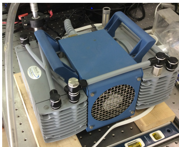
Figure 3.15 Pompe à vide utilisée. Le débit volumique maximal vaut 3.8 \text{ m}^3/\text{h} et la pression créée peut atteindre jusqu'à 2.0 mbar. Elle se situe sur deux barres en bois afin d'éliminer l'effet de la vibration.
