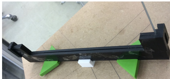
Figure 3.11 Support d'un miroir optique. La pièce blanche est taraudée afin que l'on puisse faire des ajustements mineurs d'angle.
