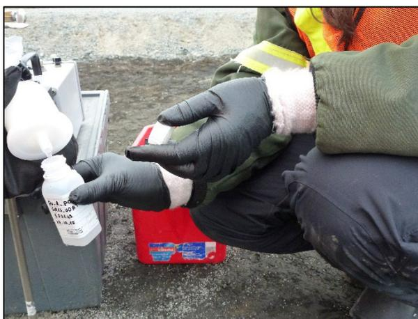
Figure 4.3 Filtration des échantillons avec une cartouche haute capacité *Waterra FHT* (0,45 µm)
