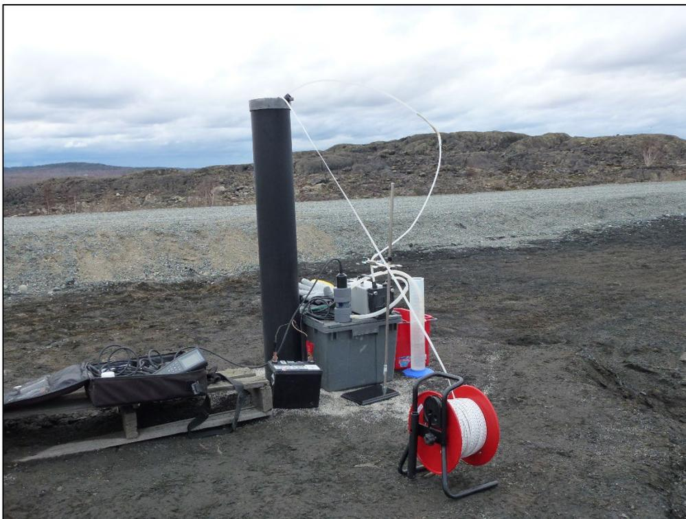
Figure 4.2 Dispositif pour l'échantillonnage à faible débit et à faible rabattement : sonde à niveau d'eau manuelle, pompe péristaltique, sonde multiparamètres, cellule passante fermée, cylindre gradué
