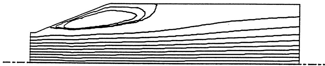
Figure 9: Lignes de courant (diffuseur axisymétrique)
