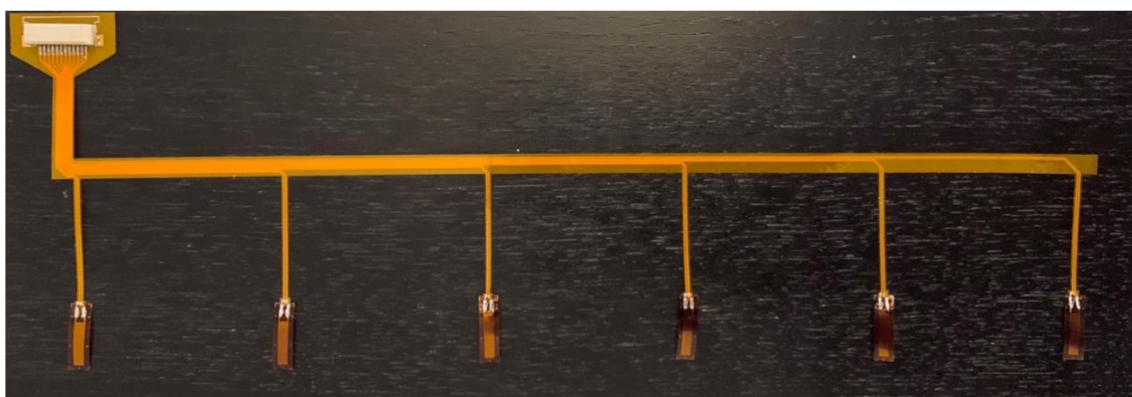
Figure 4.5 PCB flexible avec les jauges de déformation soudées suivant une direction unique
