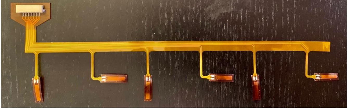
Figure 4.7 PCB flexible avec les jauges de déformation soudées suivant deux directions différentes
