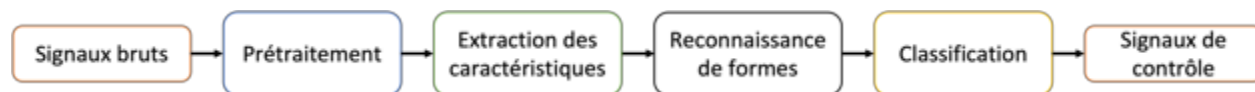
Figure 2.1 Étapes du contrôle basé sur la reconnaissance de formes. Le processus commence par les signaux bruts et se termine par une sortie de contrôle. Figure adaptée de [10]
