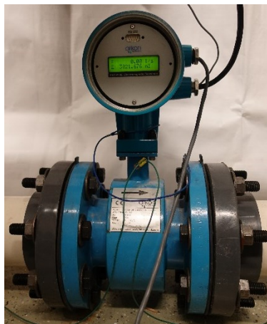
Figure 7.6 Débitmètre électromagnétique MAG910E
