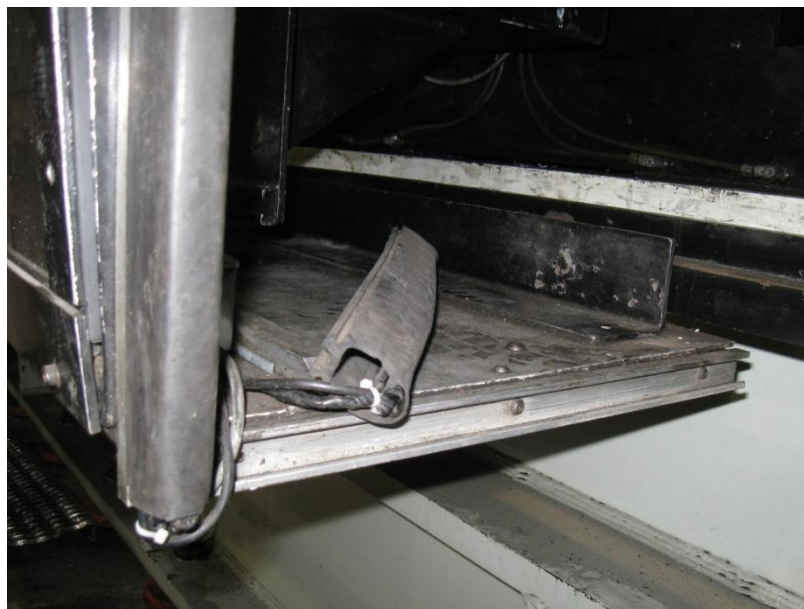
Figure 2.10 : Partie désengagée de la bordure sensible du protecteur de l'opérateur motorisé
