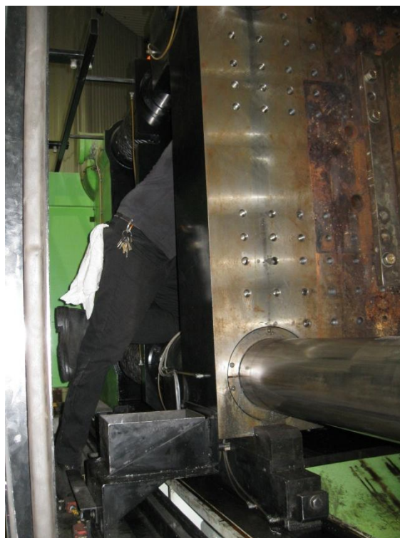
Figure 2.9 : Travailleur partiellement caché à l'arrière du plateau mobile
