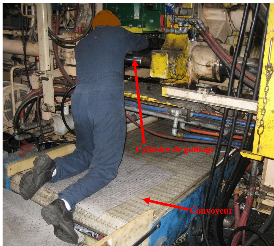
Figure 2.12 : Travailleur installant un moule en s'agenouillant sur un convoyeur
