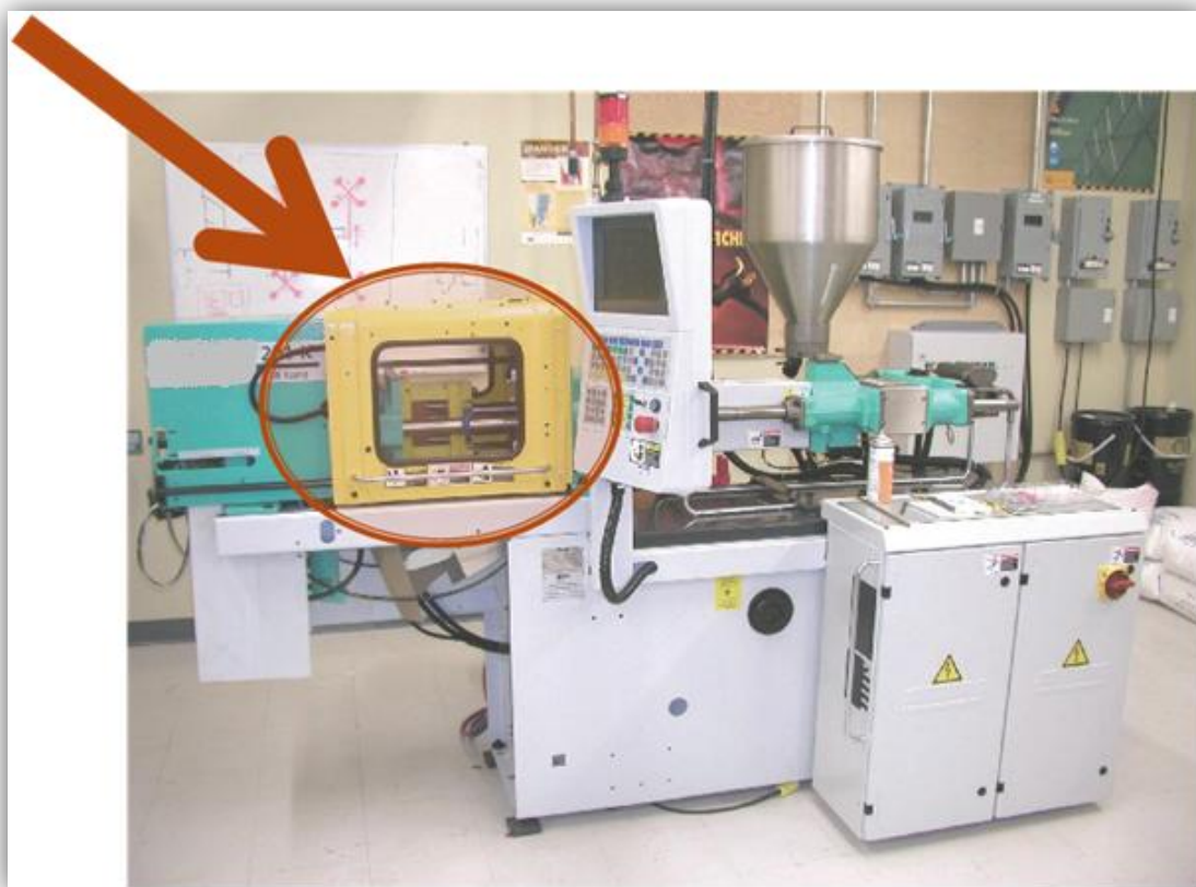
Figure 3.1 : Presse à injection de plastique horizontale de l'IRSST et son protecteur de l'opérateur [6]
