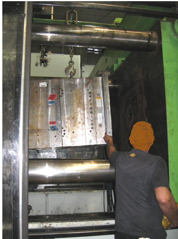
Figure 2.7 : Manutention manuelle du moule suspendu
