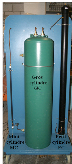
Figure 5.13 : Photo des 3 tailles de cylindres (vue du côté du dispositif)
