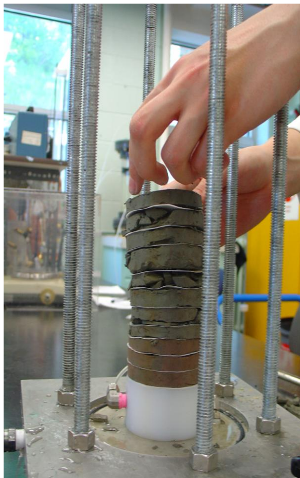
Figure 2 : Préparation et montage de l'échantillon d'argile
